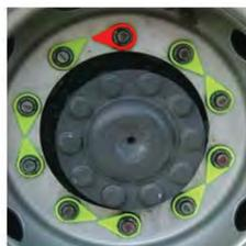
Permet d'indiquer quelle roue doit être impérativement resserrée. Il est ensuite remplacé par un checkpoint.
