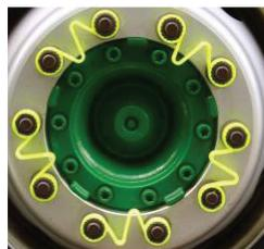
Le «Z» du Checklink s'étire en cas de desserrage, ce qui permet une indication visuelle du problème tout en évitant que l'écrou ne se détache complètement.
