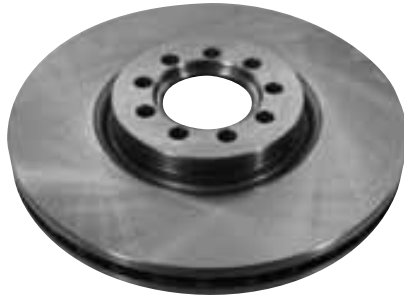
Disque avant avec ABS, diam 289 mm. Ref de la plaquette : 29229109203 Ref. 8052024 Ref OE 2996121
