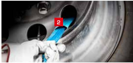
**3** Tendre la sangle avec le cliquet jusqu'à ce que la SNOWCRAMP EVO® soit solidement fixée contre le pneu.
