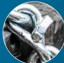
Anneaux fil rond pour réduire le frottement entre la chaîne et le pneu.
