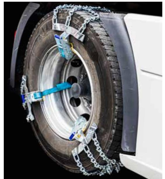
**4** Répéter l'opération pour accrocher les 3 chaînes sur la roue et équiper la seconde roue motrice du même essieu.
